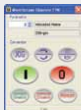
Pantalla de Monitoreo y mando utilizando HMI virtual. Función marcha/paro, JOG, local/remoto,
