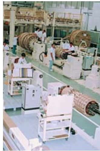
Área de fabricación de los devanados, con control de temperatura y libre de partículas
